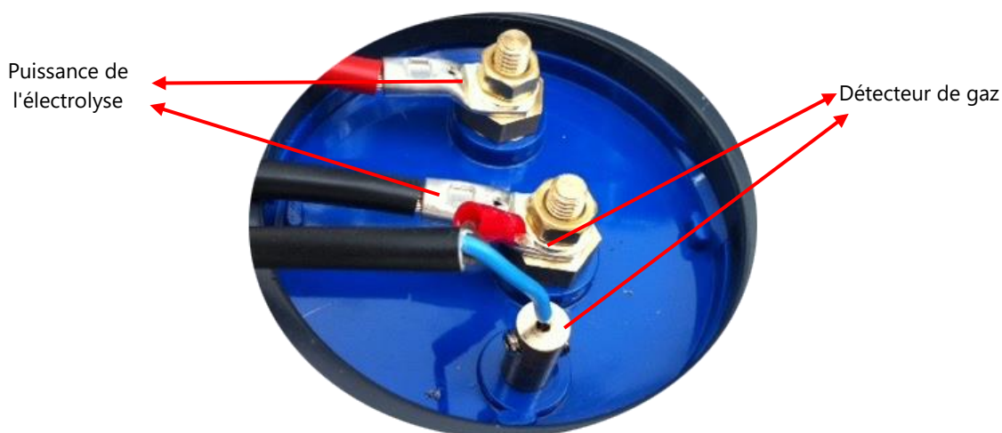
Fig 5 – Bornes de connexion de cellule d'électrolyse
